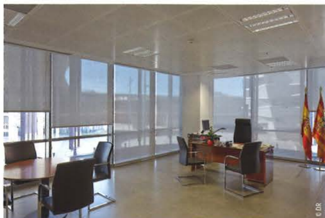
1 500 stores intérieurs à enroulement manuel de grande hauteur ont été installés dans les bureaux et tribunaux.
